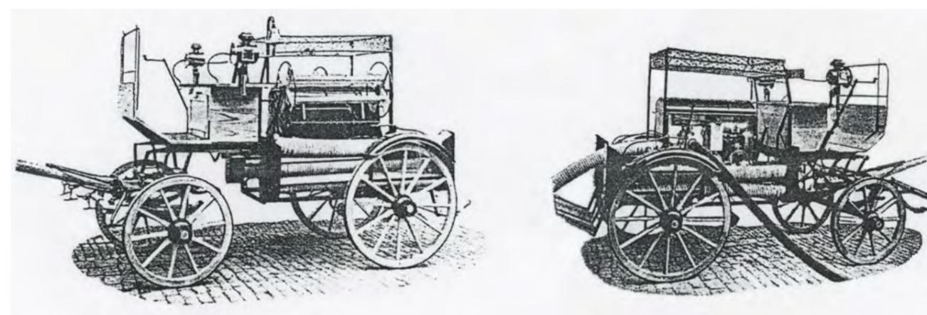
Vierrädrige Kraftspritze in Fahrstellung (links) und in Betriebsstellung (rechts) bereit für den Einsatz.
